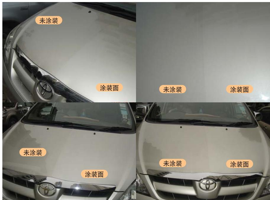
▲ 在轿车外部涂上覆盖有二氧化硅的二氧化钛光触媒后，正进行自我清洁实验。可以很清楚地确认到涂装面与未涂装面的污垢差别。由于二氧化硅的高亲水性，下雨时污垢更容易脱落。
