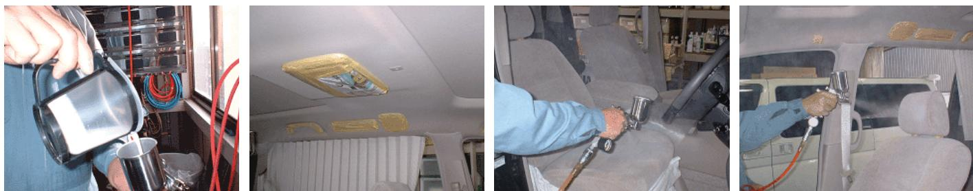
▲ 在轿车内部，喷抹内部装饰用的光触媒涂料NANOBEST NA。车辆内部几乎所有部位都可以加工，新车独特的臭味和烟草等臭味就可以都被分解、得到的是舒适的车内环境。
