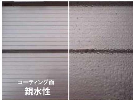
クリアな状態を維持することにより、発電力の低下を防ぎ、清掃の手間とコストを削減できます。
